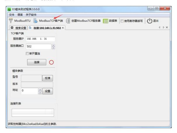
点击"连接"图标,模块网络连接建立之后,"连接"按钮会变为"断开"按钮,同时测试界面左半部分显示为设备的 TCP 客户端参数(IP 地址(默认 192.168.1.31),服务器端口(默认 502)),模块参数(型号,版本,地址),连接列表会显示所有该局域网的 IO 网络模块。测试界面右半部分为
