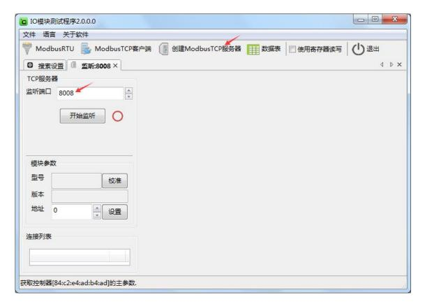
监听端口输入"8008"(注意:此端口号一定和服务器端口号一致,否则不能通讯),点击"开始监听"图标,模块网络连接建立之后,"开始监听"按钮会变为"结束监听"按钮,同时测试界面左半部分显示为设备的 TCP 服务器参数(监听端口"8008"),模块参数(型号,版本,地址),连接列表会显示所有该局域网的 IO 网络模块。测试界面右半部分为采集 DI 和 DO 的数值,DI 状态为只读值,
