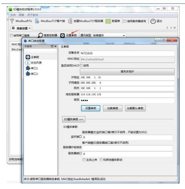
如果模块作为客户端连接到一个服务器,则"服务器IP或域名"和"服务器端口"也要设置,再点击"设置参数"图标,模块会保存新的参数并重启。如下图:
